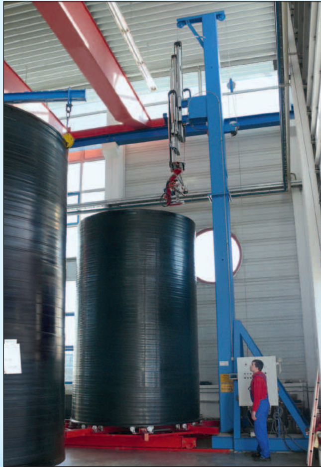
Extrusionsschweißautomat zum Verbinden des Zylinders mit dem Behälterboden
